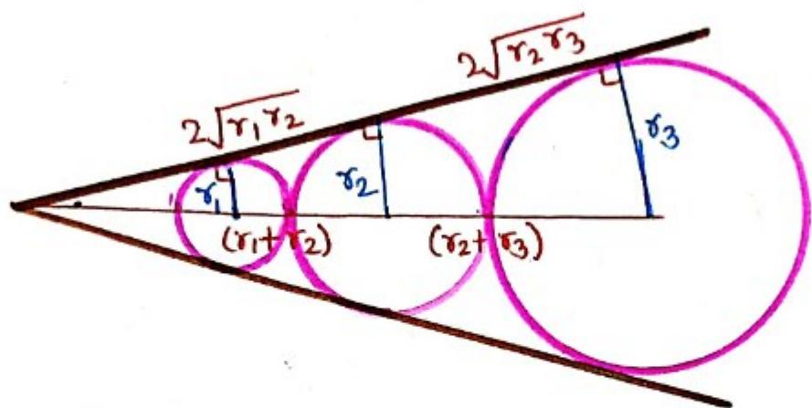
$$r_1, r_2, r_3 \rightarrow GP$$
